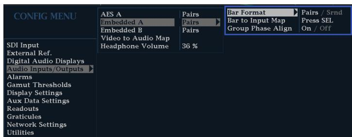
5. 选择 **Bar to Input Map**（条形至输入映射）并指定每个条形对中应该显示哪个输入对。
