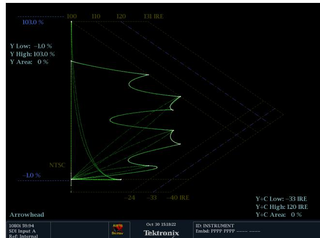
Arrowhead (箭头) 的另一个有用功能是测量有效视频信号使用动态视频通道范围的程度。经过适当调整的信号应当位于箭头刻度的中心，并具有接近所有限制的过渡。
