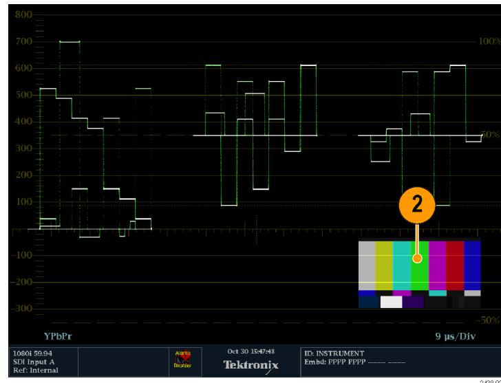
3. 再次按 **Thumbnail (缩略图)** 按钮将其熄灭并关闭图像缩略图。
