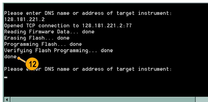
12. 要升级其他仪器，在提示符后用 PC 键盘键入该仪器的 IP 地址，然后按 Enter（回车）键，即开始软件升级。如果不需要升级其他仪器，按 Enter（回车）键退出传输工具。
