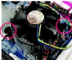
2.2.4 安装完成后请检查主板背面，卡扣脚座如下图所示，表示安装正确；
