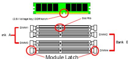
注意内存条和 DIMM 插槽上的防呆口的方向的一致性。
