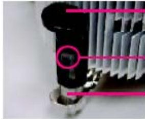
2.2.3 将风扇卡扣对准主板上的孔位，同时将其他三个卡扣用力向下压；
