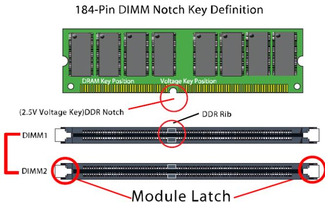
注意内存条与 DIMM 插槽上的防呆口的方向的一致性。
