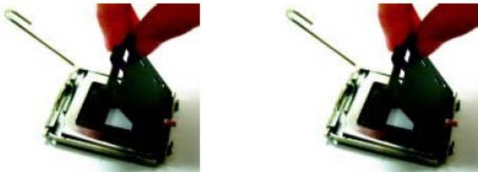
2.1.3确定处理器的第一脚位置, 正确安装后, 然后将金属盖放下, 并将插座连杆拉回到锁住的位置上;
