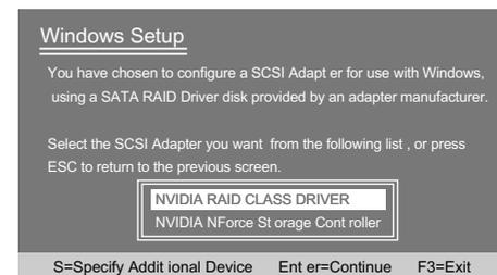
出现上图画面后，选择“NVIDIA RAID CLASS Driver”后按 Enter键安装后，重复上面的步骤：按S键添加驱动，安装“NVIDIAForce Storage Controller”。以后的安装过程和普通的硬盘安装方法完全相同。
