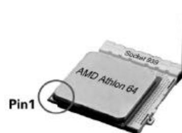
2.1.3 确定处理器是紧紧扣在CPU的脚座中，然后将拉杆放下紧紧扣在CPU脚座旁边的固定位置上。
