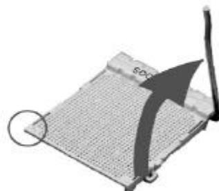
2.1.2 安装处理器的时候，请注意下图中的圆圈，此处的 CPU脚座为半缺口的形状，请将处理器的脚针半缺口的一边和CPU 脚座相对应。
