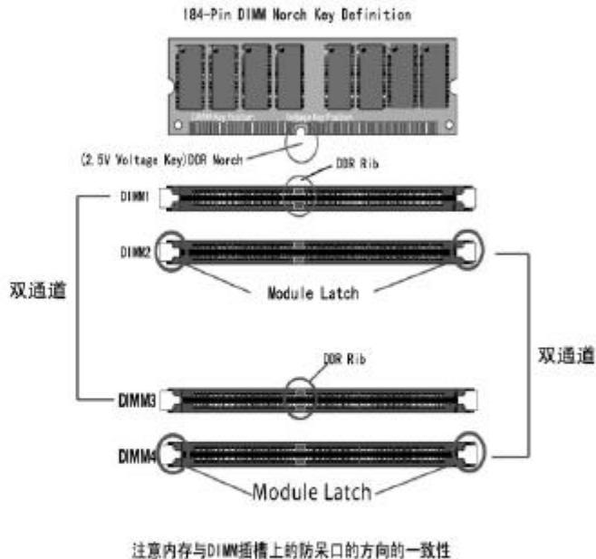
注：在完全断开AC电源的情况下，轻压内存槽两边的白色卡扣，内存自然从内存槽中松开，即可取出内存条；主板支持双通道，插DIMM 1 和DIMM 3 可以组成双通道，插DIMM 2和DIMM 4或四根插槽全部插满可以组成双通道；主板上四个DDR DIMM 插槽分为两个通道：通道A：DIMM 1和DIMM 2；通道B：DIMM 3和DIMM 4。
