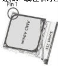
2.1.3 确定处理器是紧紧扣在CPU 的脚座中，然后将拉杆放下紧紧扣在CPU脚座旁边的固定位置上。
