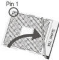
2.1.2 安装处理器的时候，请注意下图中的圆圈，此处的CPU 脚座为半缺口的形状，请将处理器的脚半缺口的一边和CPU脚座相对应。
