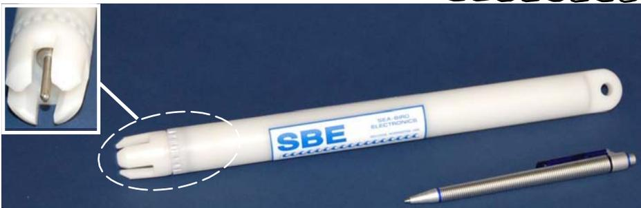
SBE56 配有 0.5 秒时间常数的压力保护热敏电阻器，提供优良的精度和分辨率，可进行频率为 2Hz 的快速采样。它具有优异的稳定性；漂移典型值小于 0.002°/每年。配备 64 MB 内存，高准确度的实时时钟，耐压塑料外壳的深度可达 1500 米。用户接口为 USB 2.0 接口，配有易于使用的基于 Java 的通信软件，实现数据上传，数据转换等其他功能，对所有的计算机操作系统均适用。
