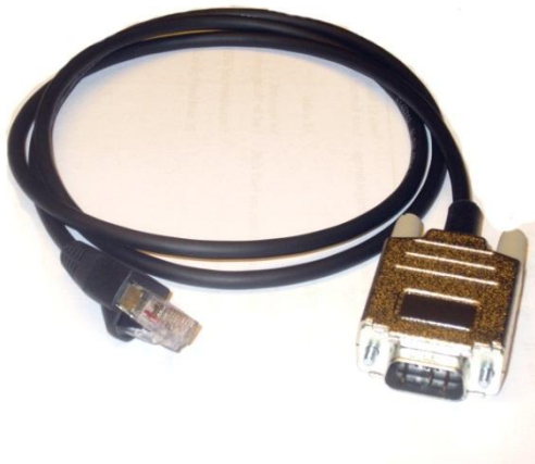
Cable E3c – I/O to K3 ACC jack
