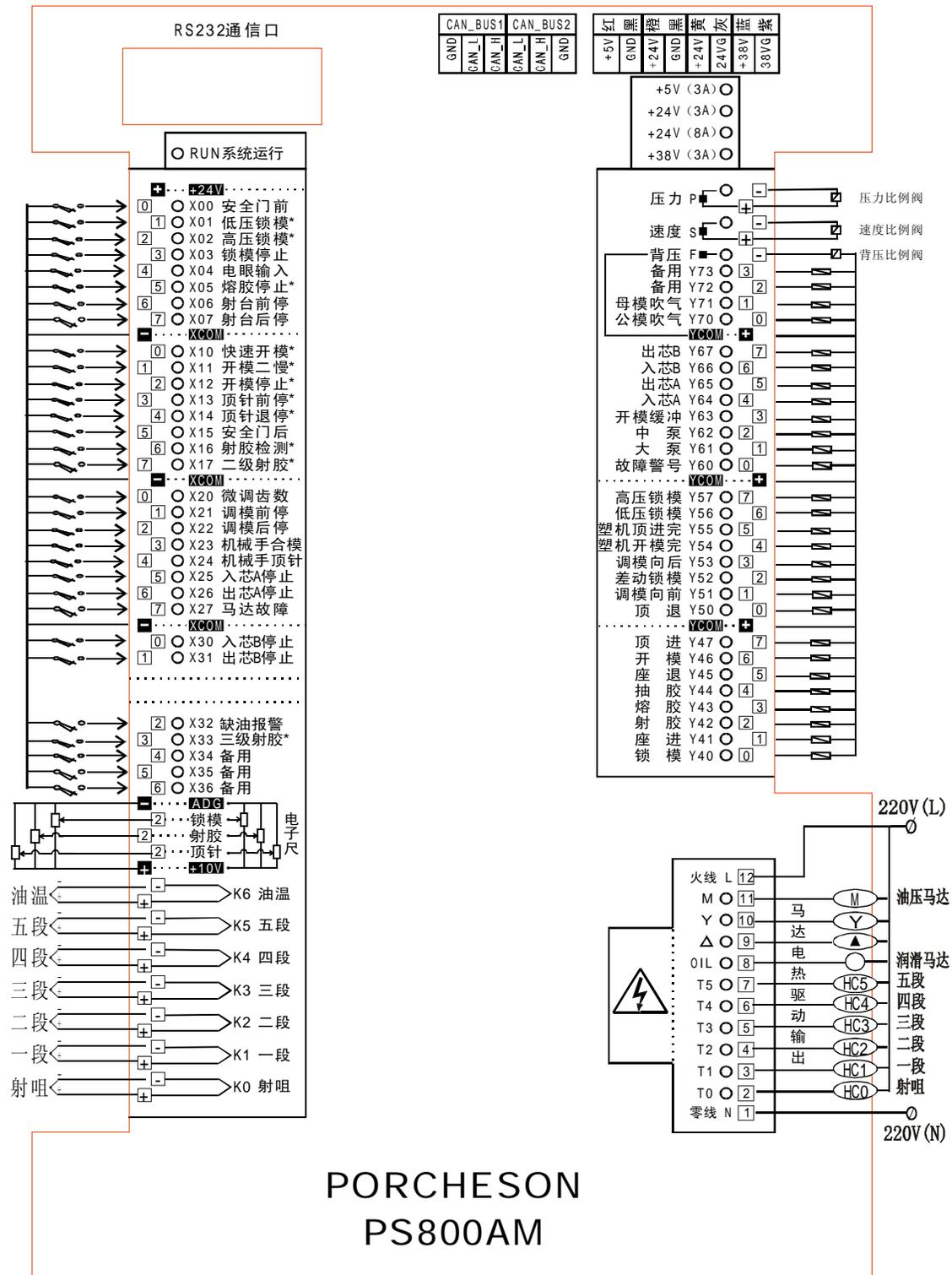
PS800AM输入输出接线图
