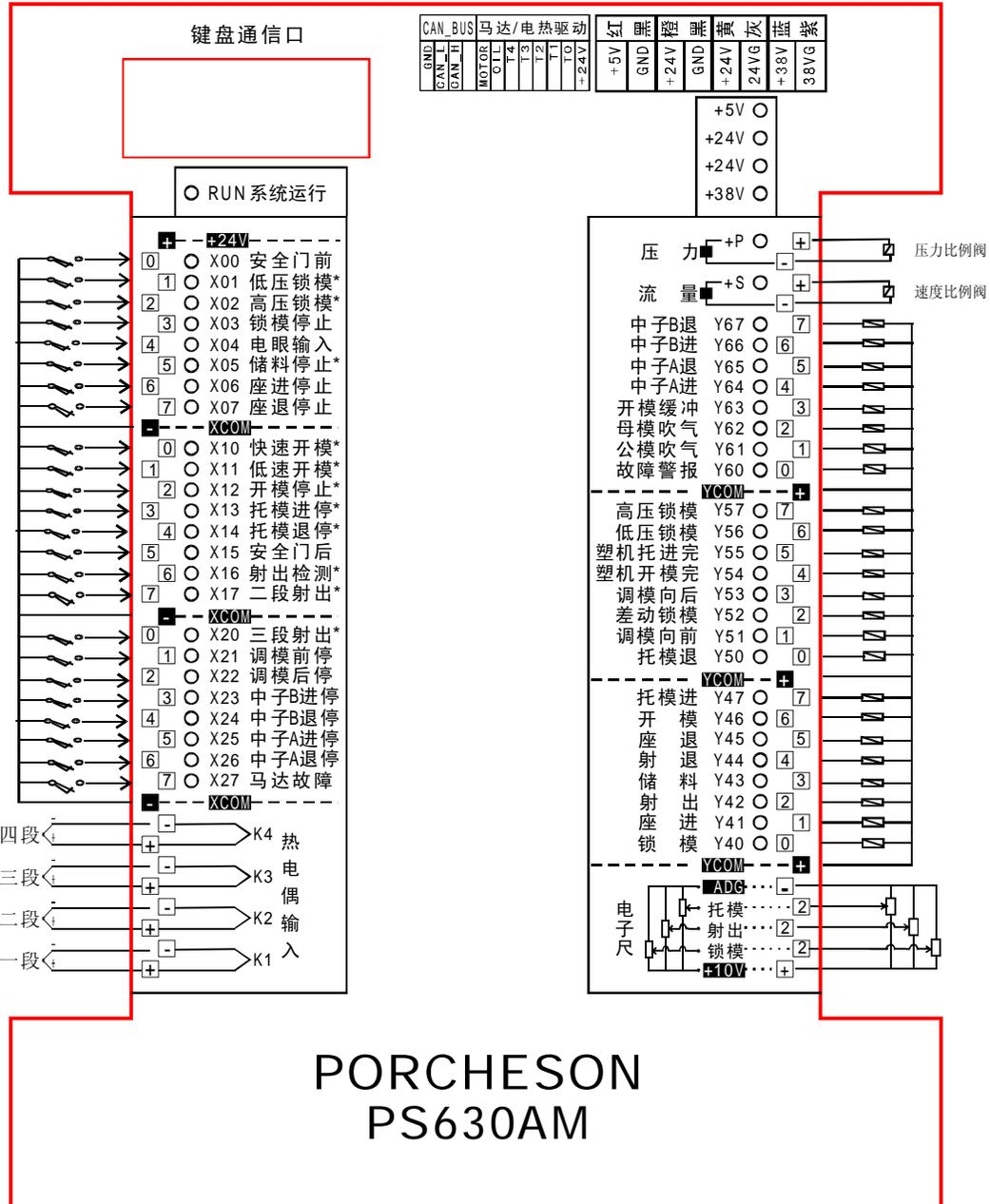
PS630AM输入输出接线图
