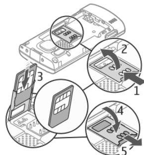
确保 SIM 卡的触点向下朝向设备，并且切角向下朝向 SIM 卡卡夹。
