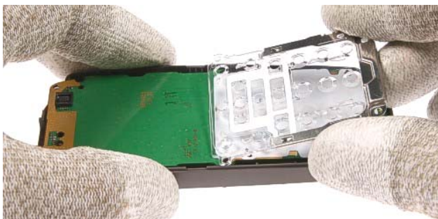
15.) Remove the Light Guide Assy .
