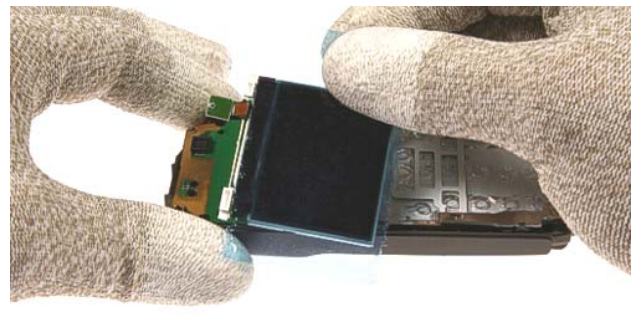
14.) Remove the LCD Module .
