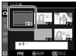
若要使用新的白平衡值，请选择预设 d-0 ( 在选择 d-0 前若未测量白平衡值，白平衡将设为色温 5,200 K，与 [ 直射阳光 ] 相同 )。新的白平衡值将保留在预设 d-0 中，直到重新测量白平衡。测量白平衡新值前通过复制预设 d-0 到任一其它预设中，最多可存储 5 个白平衡值 ( 第 154 页 )。
