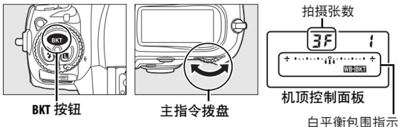
在 0 以外的其它设定下，机顶控制面板中将显示白平衡包围指示，且机顶和机背控制面板中将出现 **WB+BKT** 图标。
