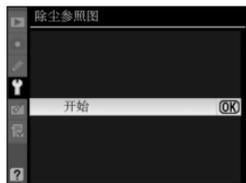
屏幕中将显示如右图所示的信息，并且取景器和机顶控制面板中将出现“rEF”。若要获取影像除尘数据而直接退出，请按下 **MENU**。
