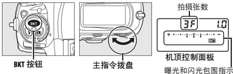
在 0 以外的其它设定下, 取景器和机顶控制面板中将出现 **BKT** 图标与曝光和闪光包围指示。
