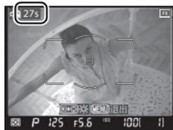
在非手动曝光模式中，请在对焦后关闭取景器接目镜快门。这样即可防止光线从取景器进入而干扰曝光（第 100 页）。
