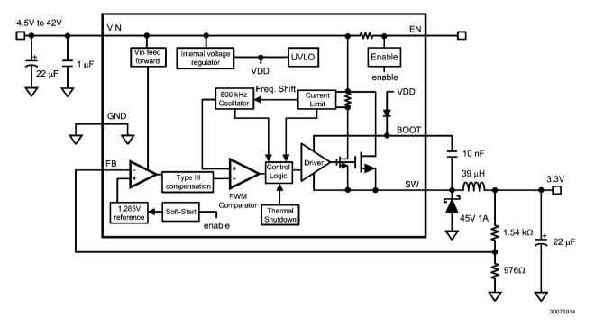
FIGURE 1. 3.3V  $V_{\rm OUT}$ , 500 mA
