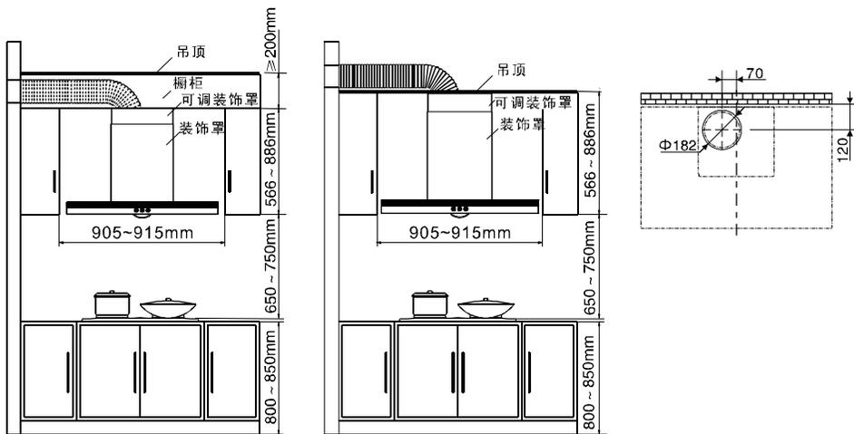
**2. 安装机体挂板:** 按照下图所示在墙壁相应位置钻出4个直径为 $\Phi 8$ mm、深度为50mm的孔，将膨胀管压入孔内，再用随机配备的4枚5×50十字槽沉头木螺钉将机体挂板可靠固定。
