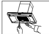
3. 定期清洗进风罩，建议每月最少一次，清洗方法如下：打开固定进风罩的螺钉，取下进风罩，放入加有中性清洁剂的温水浸泡，用软刷清洗干净后晾干，装好即可。
