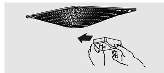
● 将油杯内的两个滑槽导入进风罩上L形挂钩，轻轻推进，卡牢即可。
