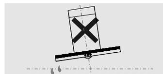
● 吸油烟机安装后，应保持左右水平。
