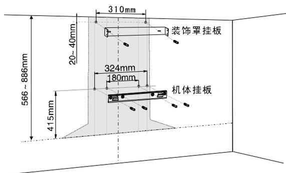
**3. 安装机体:** 将机体后部的挂孔对准机体挂板的挂钩嵌入，并用手晃动机体检查，确认机体安装水平和牢固。
