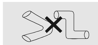
2) 排烟管伸出户外或通进公用吸冷风烟道，接口处要严密，不允许将废气排到热的烟道中。
