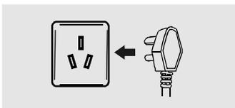
● 请使用单相带接地插座，并保证电源插座的地线端接地可靠。长期不使用时，请将电源插头拔出。
