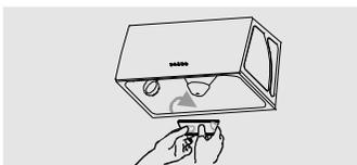
● 握住油杯底部外缘，将卡扣插入卡座，顺时针方向旋转，卡牢即可。
