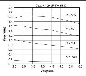
FIGURE 24-7: TYPICAL RC OSCILLATOR FREQUENCY vs. VDD
