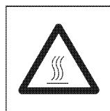
**警告：**校准部件可能仍然很热。因此，应首先使之冷却下来后再从样品盘支架上取出样品盘（此段原文与下段相同，疑有误 - 译注）。温度校准结束后，仪器自动退出该菜单并返回至待命状态，准备作下一步测量。
