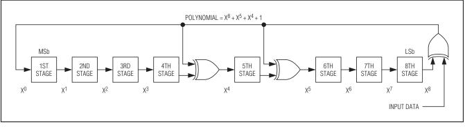
Figure 32. 8-Bit CRC Generator
