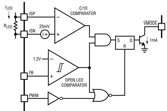
1.  $\overline{\text{VMODE}}$  ASSERTS WHEN  $V_{ISP-ISN} < 25\text{mV}$  AND  $\text{FB} > 1.2\text{V}$ , AND IS LATCHED
