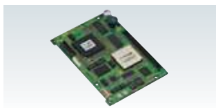
AVC-Intra编码卡 AJ-YBX200MC ※ 以H.264为基础的新高清编解码器，可进行记录重放。
