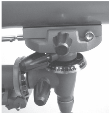
图 2-18 114EQ 望远镜镜筒的鸠尾槽上的锁紧螺丝和安全螺丝
