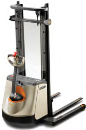
ST 3000 系列 步行跨腿式堆高机 额定承载重量：1000 kg 提升高度：2400 至 4250 mm
