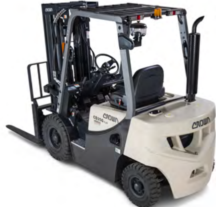
C-D 系列, CD 20-35G 型号 轮胎：充气胎 动力：内燃 - 柴油 额定承载重量：2000 至 3500 kg 提升高度：3000 至 5990 mm
