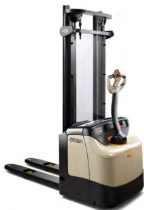
ES / ESi 4000 系列 堆高机 额定承载重量：1200 至 1600 kg 提升高度：2440 至 5400 mm
