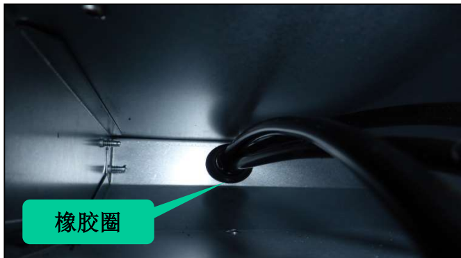
取下橡胶圈将两根风阀线从圆洞中退出， 注意不要损毁电源线
