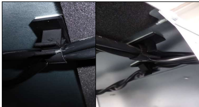
从粘贴在上盖板的两个卡子中取出电线
