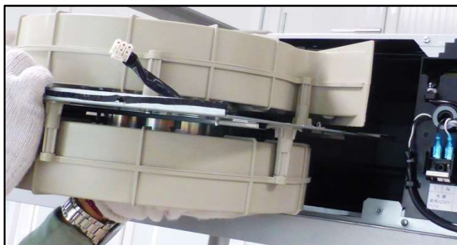
组件取出时，注意安全；并确保马达组件取出时 注意不要碰伤电源线
