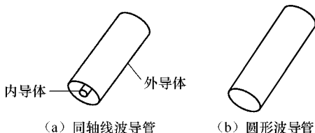
图 6-2-2 圆形波导管的结构
