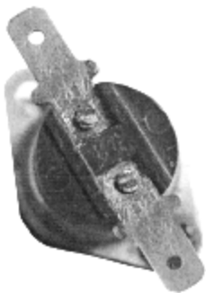
图 2-5-4 热继电器（微波发生器 145℃热动开关）
