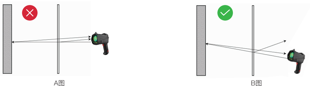
图4.6 透过玻璃检测时正确与错误示范
