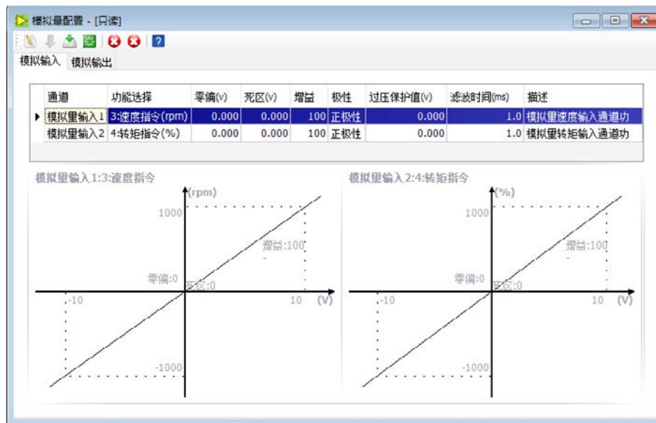
模拟量输入可以在图示中设定增益、零偏、死区等参数
