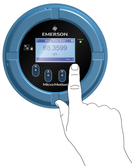
图 8-1: 激活光开关的正确手指位置
