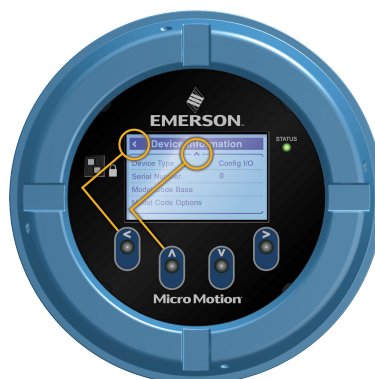
图 8-2: 示例 1: 激活变送器显示器上的箭头指示器
