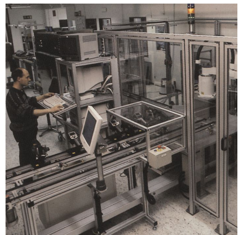
圖 23.5 左圖：在環境室中測試紅外線熱像儀；右圖：熱像儀測試和校準機器人
