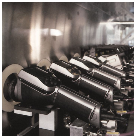
圖 23.5 左圖：在環境室中測試紅外線熱像儀；右圖：熱像儀測試和校準機器人
