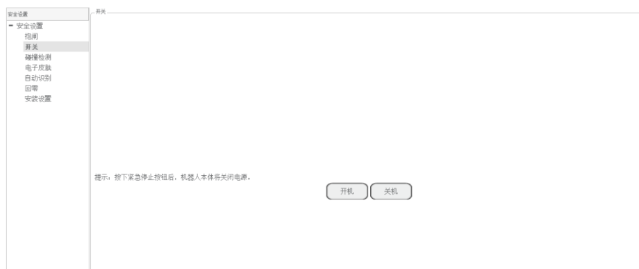
图 3.21 控制机械臂上电和下电
