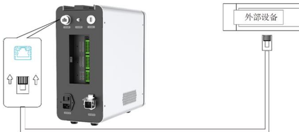
图 3.30 Dobot 机器人控制系统与外部设备直连
