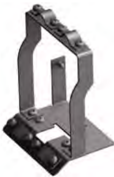
可实现电缆屏蔽层360°接地的PE盘
