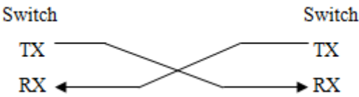
图 A-4 光纤连接示意图
