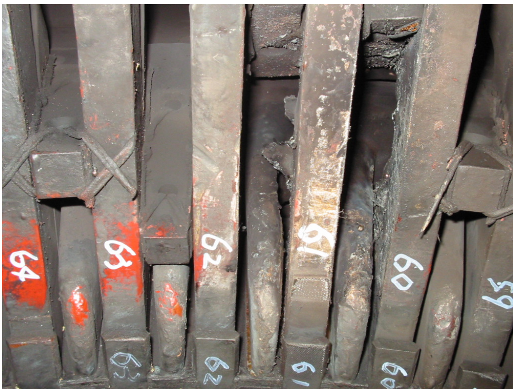
图 7.2-9 发电机定子端部故障线棒放大视图
