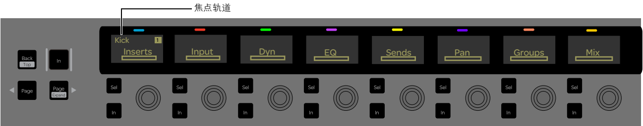
通道控件顶层旋钮组 - 最左侧显示屏中显示焦点轨道
