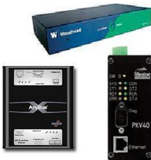
图 7. HMS、Hilscher、及 Woodhead 提供的第三方网关
