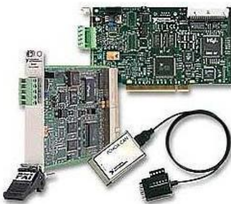
图 3. 美国国家仪器有限公司即插式 DeviceNet 接口
