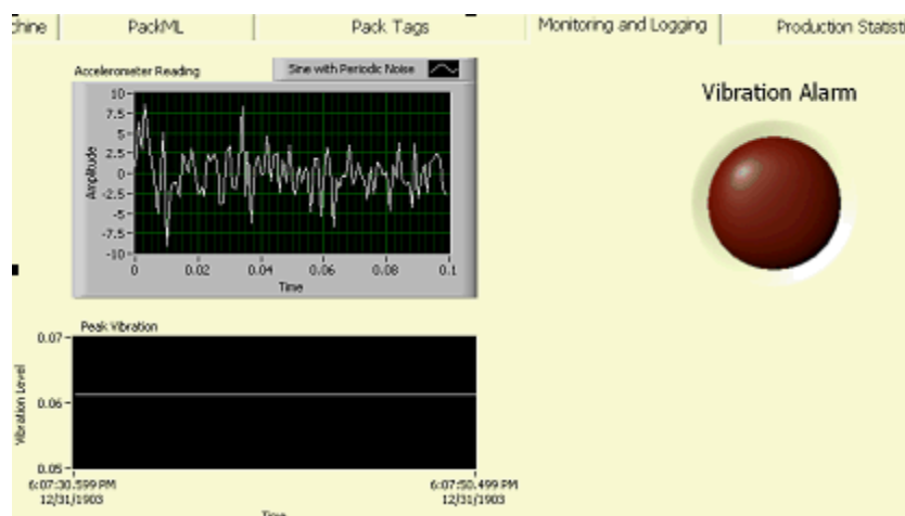
图 2, 对 LabVIEW 中振动监测的加速计数据的分析
