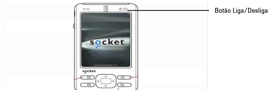
Figura 5. Estação de dados e local do botão Liga/Desliga
