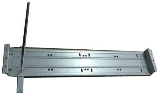
③将光驱支架固定到硬盘支架上。
