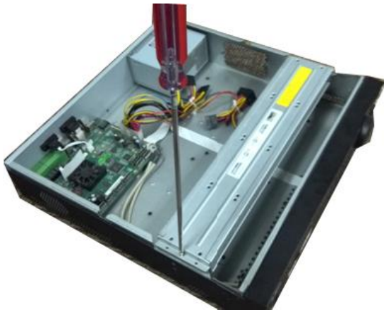
①打开机箱上盖，移除硬盘架。
