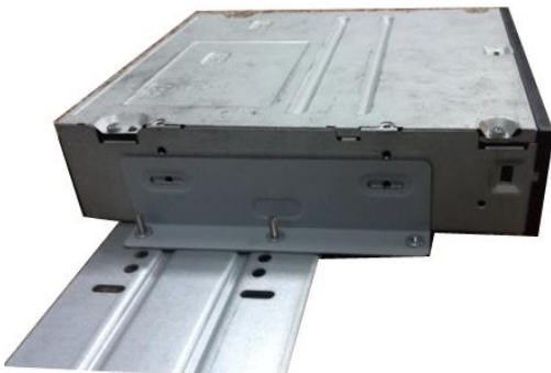
③将光驱支架固定到硬盘支架上。
