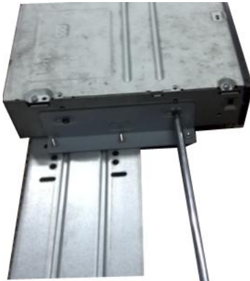
⑥用螺丝刀拧紧螺丝。
