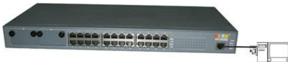
图 6-1 与 Console 口的连接方法举例
