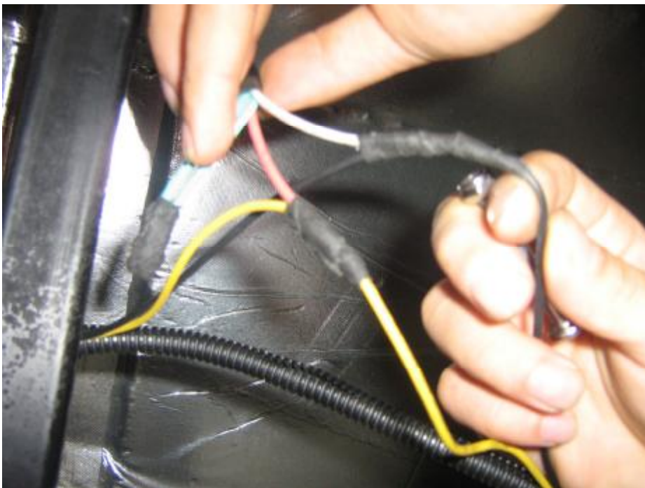
图 8 喇叭走线安装示意图 2
