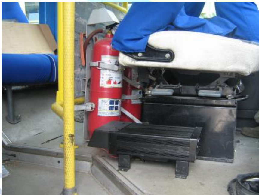
图1 多媒体车载机主机安装示意图
