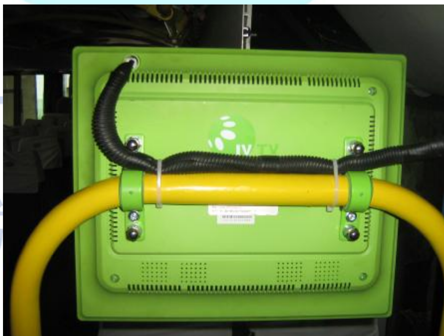
图 4 多媒体车载显示屏安装示意图 3
