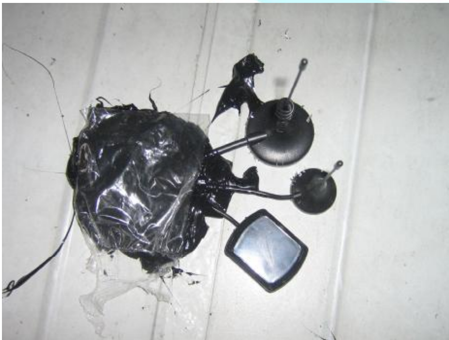
图 6 车载机 GPS、GPRS、WIFI 天线安装示意图
