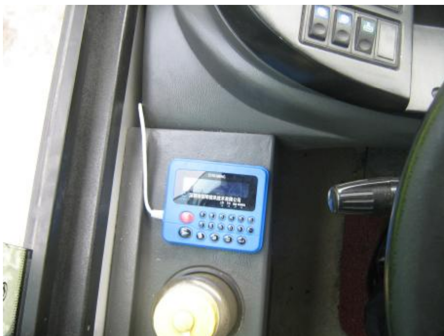
图 5 多媒体车载机报站键盘安装示意图
