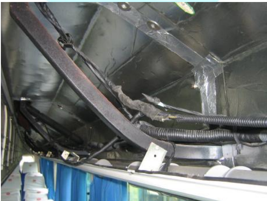
图 8 喇叭走线安装示意图 2
