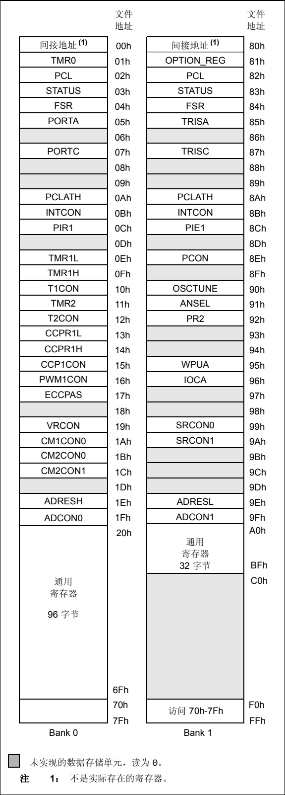
图 2-4: PIC16F616/16HV616 的数据存储器映射
