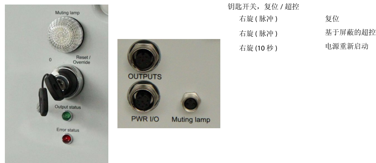
图 15: Muting 盒上的复位 / 超控钥匙开关与来自连接器 PWR I/O — 针脚 8 ( 启动 ) 的启动信号的作用相同
