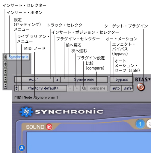
Synchronic のプラグイン・ウィンドウ (RTAS バージョンの例)
