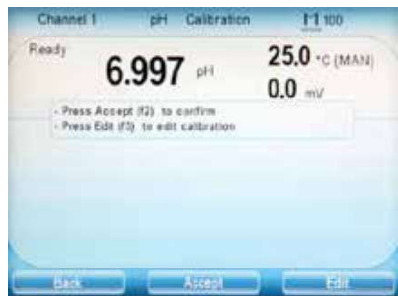
示例 3：pH 缓冲液读数稳定后，屏幕文本提示和功能键会更新相应的说明和选项。
