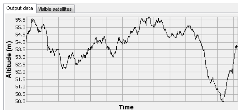
图 8 HG-DSPGPS V1.3 定位高度曲线
