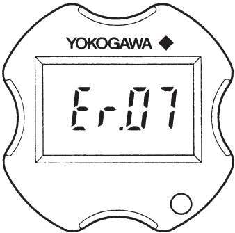
图 8.5.1 用内藏指示计检查故障
