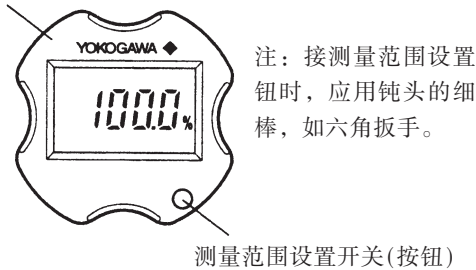
图 7.6 测量范围设置开关
