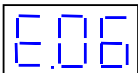
(图五) 模块故障显示
