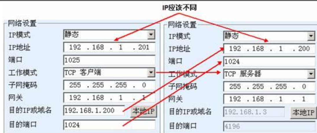
图 19 TCP 设备对联参数配置
