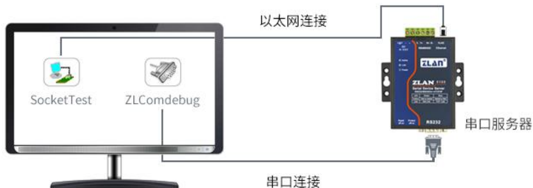
图 7 TCP 通讯示意图
