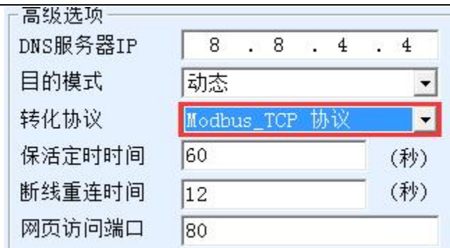
图 14 启用 Modbus TCP 功能
