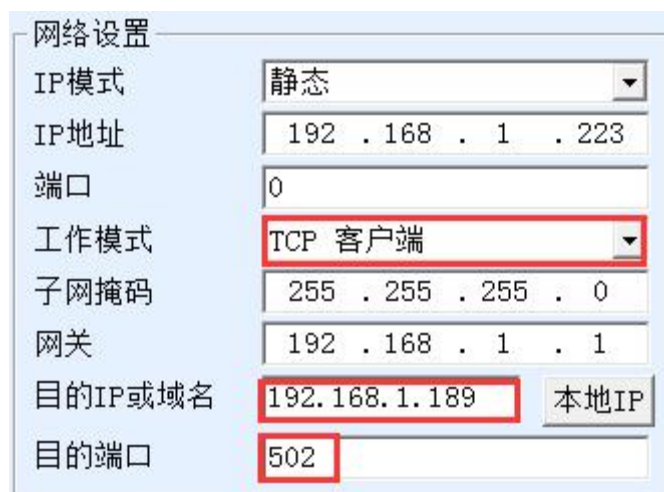
图 15 Modbus TCP 做客户端。
