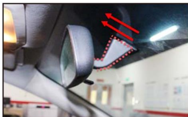
1. 拆除原车中的后视镜。握住虚线标识的后视镜支架沿着箭头方向将原车后视镜拔出。
