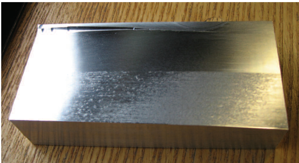
Figura 2: A distribuição uniforme de pontos (na metade superior do bloco) resulta em um melhor acabamento da superfície, em comparação com os pontos distribuídos “fora de ritmo” em transmissões adjacentes (metade inferior do bloco).
