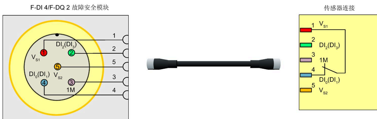
图 5-1 F-DI 应用模式 1：内部传感器电源（所示为单通道传感器的 1oo1 评估）
