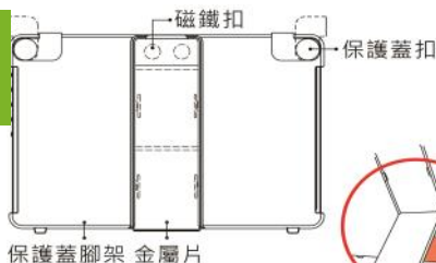
左圖: On-Lap 1102E/H/I「保護蓋立架 Cover Stand」部位說明
