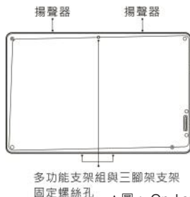
▲圖: On-Lap 1102E/H/I 螢幕與傳輸線部位說明
