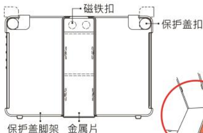
左图：On-Lap 1102E/H/I 「保护盖支架 Cover Stand」部 位说明
