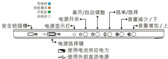
▲ 图：On-Lap 1102H 按键，LED 灯号、与安全锁插槽说明
