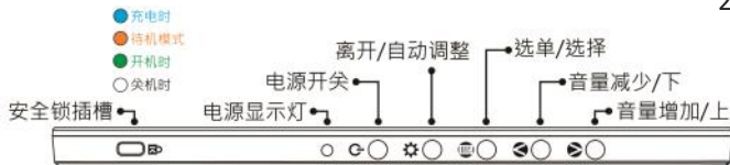
▲ 图：On-Lap 1102E/I 按键，LED 灯号、与安全锁插槽说明
