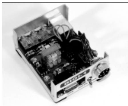
Digi-1 passt NF-Pegel an, bringt Impedanzen auf einen Nenner und entkoppelt
